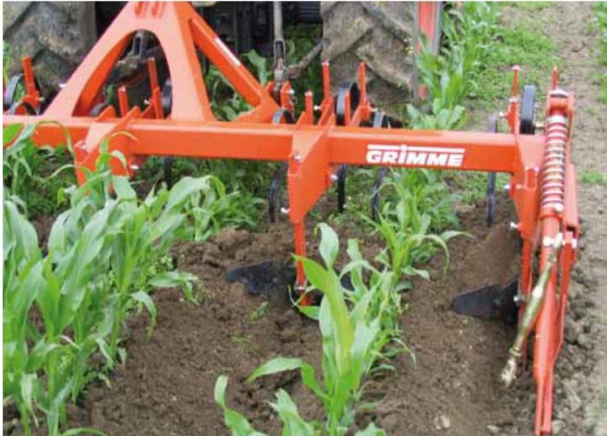
Abb. 41: Häufeln in Mais zur Unkrautregulation in der Reihe (Mücke 2011)
